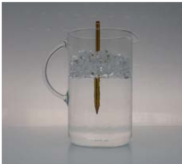
Figura 2. Lapicero atravesando el aire, las bolas de hidrogel en aire y las bolas de hidrogel sumergidas en agua.
