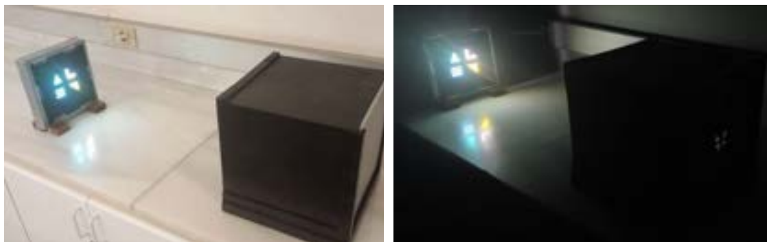
Figura 7. Cámara oscura realizada con madera (izquierda) y fotografía procesada para poder observar simultáneamente el objeto y la imagen invertida de la cámara oscura (derecha). Como fuente de luz se usa un plafón led al que se le ha añadido una máscara con formas de colores
