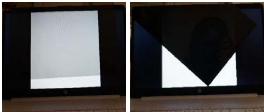
Figura 2. Polarizadores sobre pantalla del ordenador en dos posiciones: (izquierda) polarizadores paralelos; (derecha) polarizadores rotados entre sí 90^\circ , provocando de extinción total.
