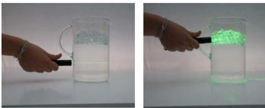
Figura 1. Haz láser atravesando las bolas sumergidas (izquierda) y las que están en el aire (derecha)
