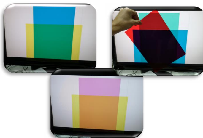
Figura 2: Mezcla sustractiva de colores usando una linterna como fuente (imágenes superiores) o una pantalla de ordenador (imágenes inferiores).
