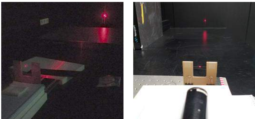
Figura 2. Haz láser pasando por un pelo (izquierda y centro) y el
