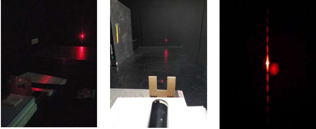
Figura 2. Haz láser pasando por un pelo (izquierda y centro) y el patrón de difracción que genera (derecha)
