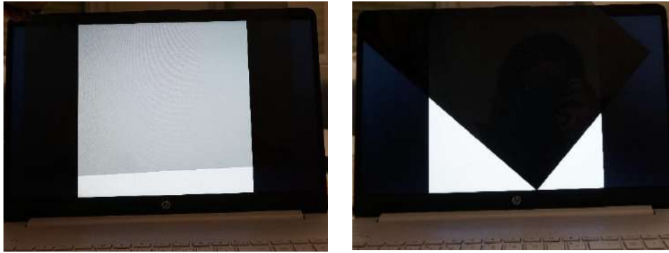
Figura 2. Polarizador sobre pantalla del ordenador en dos posiciones rotadas entre sí 90^\circ , provocando de extinción total
