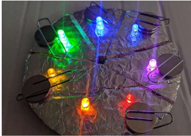
Figura 3. Círculo de Newton con LEDs
