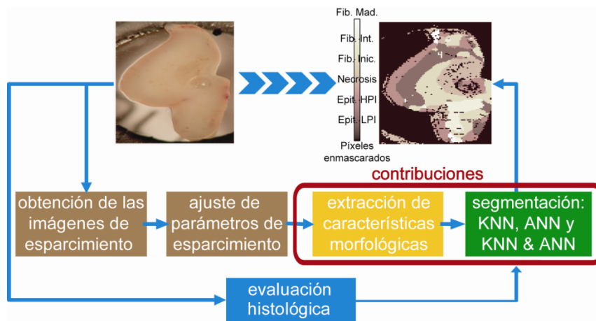
Fig. 7: Esquemático del sistema global para la identificación de la morfología del tejido mediante espectroscopia de imagen.
