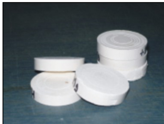
Fig. 1: Pastillas de \text{Ca}(\text{OH})_2 fabricadas a partir de soluciones líquidas con concentraciones conocidas de Mg (Dimensiones: diámetro 3 cm \times espesor 1 cm).
