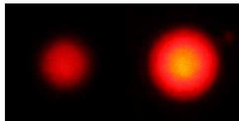
Fig. 8: Distribución transversal de la potencia emitida (modo TEM 00 ). En la foto con sobreexposición se aprecia la simetría radial de la distribución.
